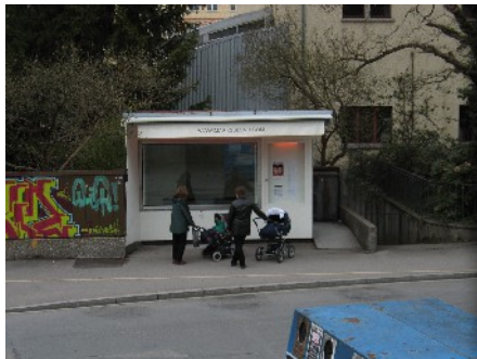
pick up: Kiosk im Wohnviertel, mit blauem Glascontainer. Vorderfront des Kiosks mit Schalllöchern, darüber Ultraschall-Distanzsensor und Glasscheibe. Zwei Passanten, die sich angesprochen fühlen.
